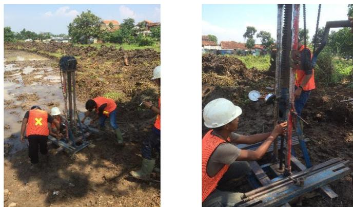
Gambar 3: Pelaksanaan CPT (*Cone Penetrometer Test*)
